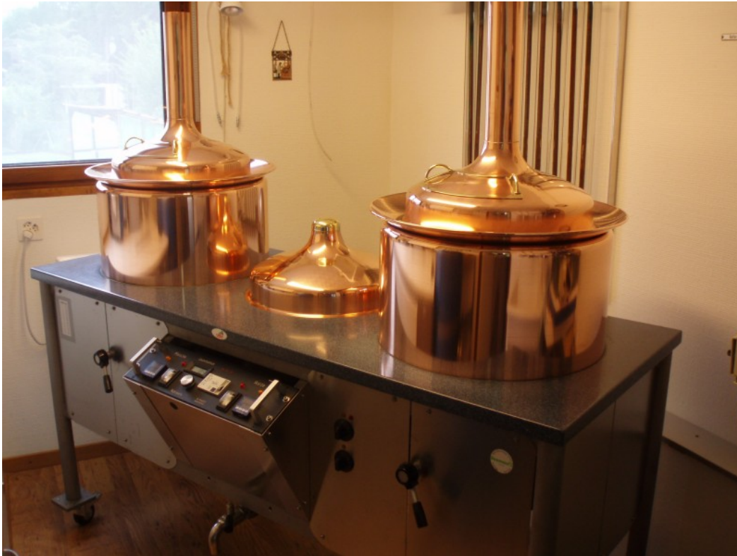
Abb. 3: selbst gebautes 50 Liter Doppelsudwerk
